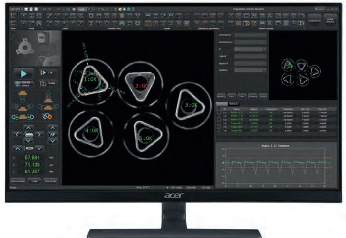
Il programma di misura **VisionX Pro** permette di acquisire e visualizzare rapidamente elementi geometrici tramite **analisi di immagine**.
