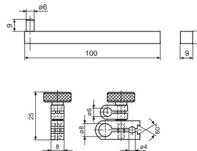
**2341311** Attacco per comparatore o tastatore.
