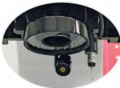
Gruppo ottico con puntatore laser e tastatore
