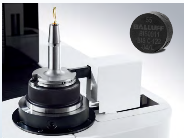
Après avoir mesuré l'outil, les données sont écrites sur le support de données Balluff (puce)/Dopo aver misurato l'utensile, i dati vengono trasferiti al supporto dati Balluff
