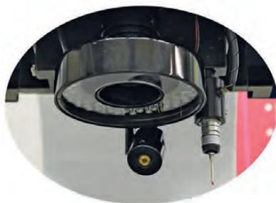
Gruppo ottico con puntatore laser e tastatore
